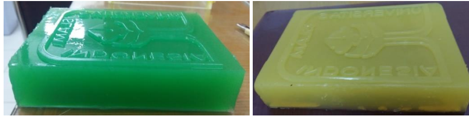
Gambar 4.8 gel yang telah berubah warna karena cairan elektrolit.
