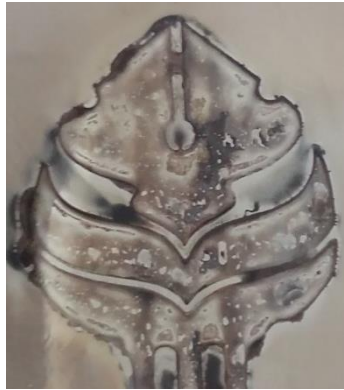
Gambar 4.3 hasil plating gel yang banyak gelembung
