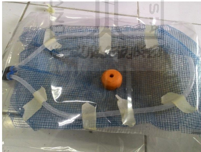
Gambar 4.22 Pemasangan Strimin , Selang Spiral , Plastik Klip dan Connector
