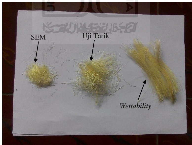
Gambar 4.3 Serat Untuk Uji SEM, Uji Tarik dan Uji Wettability
