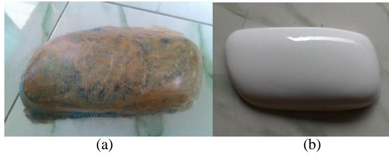
Gambar 4.24 Hasil Jadi Produk, (a) Sebelum finishing, (b) Sesudah di finishing
