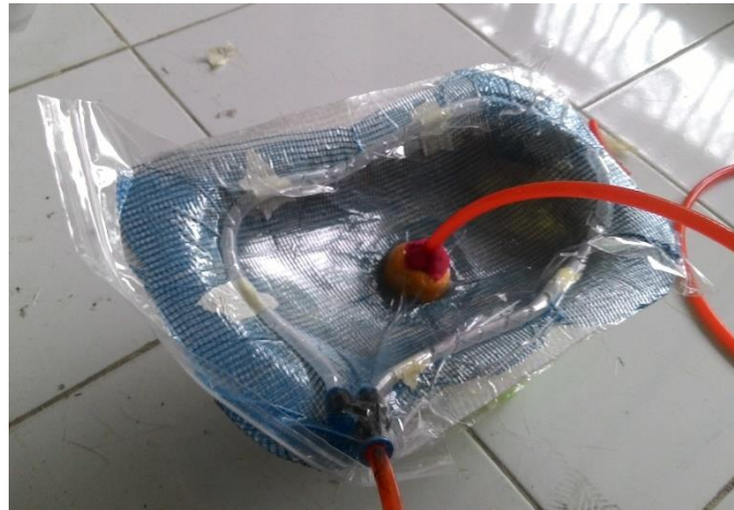
Gambar 3.23 Proses Pengecekan Kebocoran dan Pemvacuuman Cetakan
