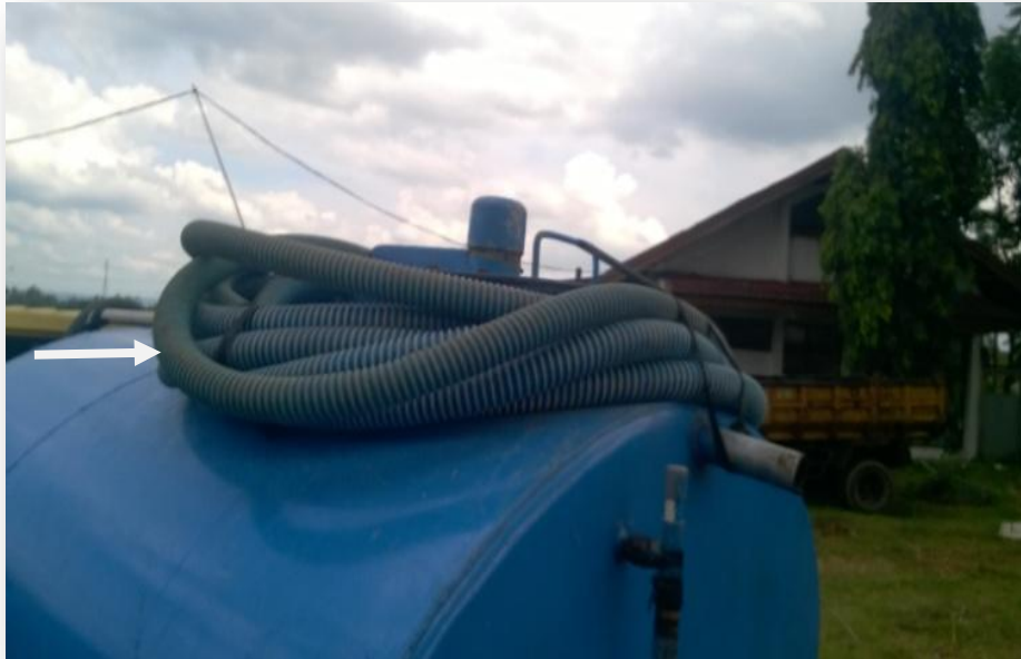
Gambar 4.3. Selang penyedot Lumpur Tinja berdiameter 2 inchi
