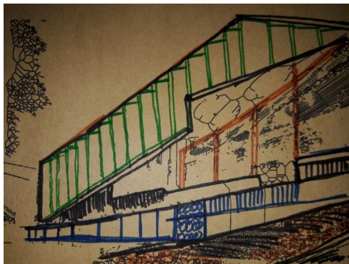
Gambar 80 Penerapan Light shelf pada Bangunan
