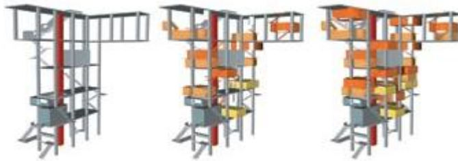
Gambar 3.2.1 Struktur Framework pada Growing House
