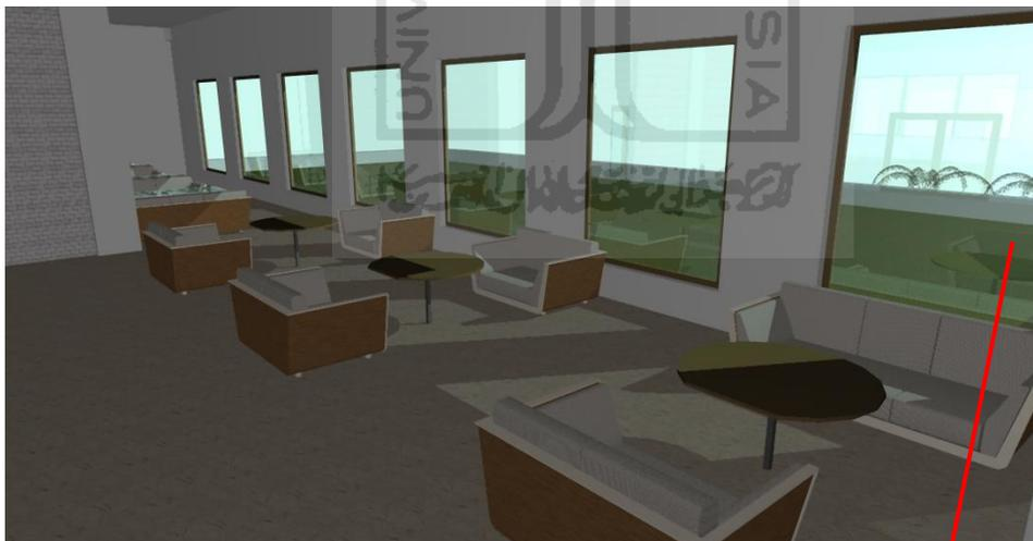
Sesuai dengan analisis sebelumnya, bahwa ukuran bukaan jendela tidak boleh melebihi ukuran frame curtain wall dikarenakan untuk membatasi sinar matahari yang masuk. Gambar di atas pengujian ukuran bukaan (tanpa frame curtain wall, terlihat dengan adanya batas atas berupa dinding pada jendela yang berfungsi sebagai penghalang masuknya sinar matahari jatuh tidak terlalu dalam pada ruangan. Oleh karena itu dengan penggunaan frame nantinya ukuran jendela tidak melebihi frame curtain wall.
