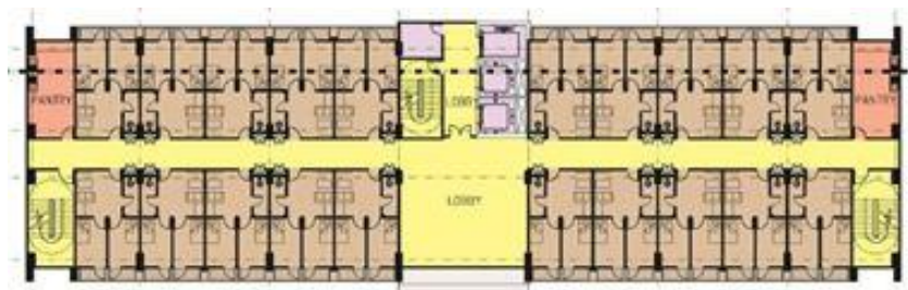
Gambar. Denah bangunan Tipe Linier Tunggal
