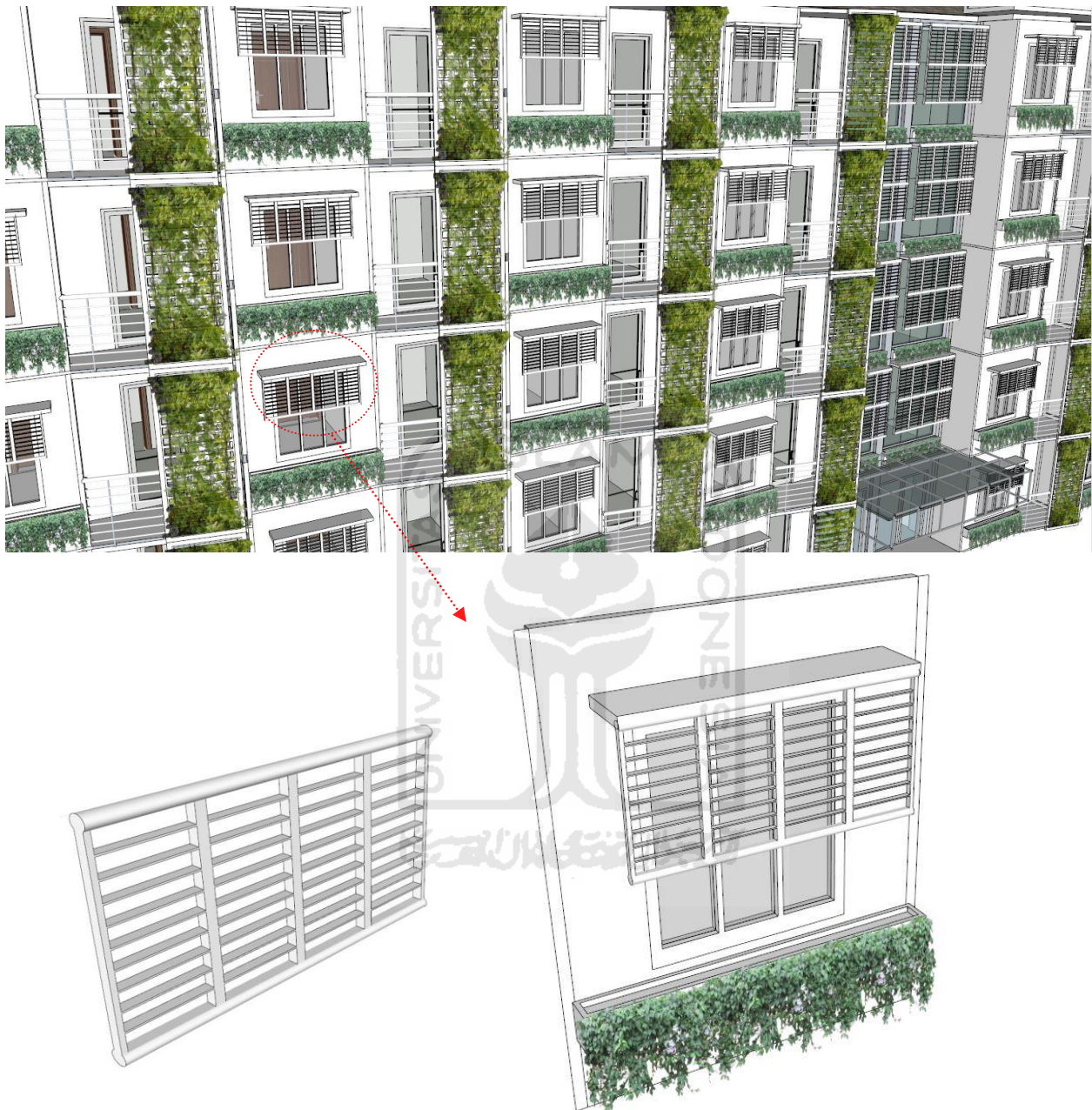
Gambar. Perangkat Shading / Louvers pada jendela Fasad Barat
