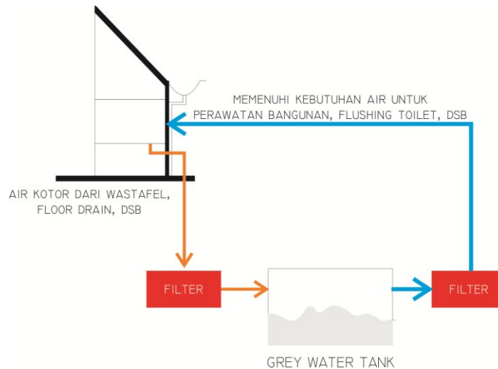
Gambar 3.4.4 Skema Grey Water
