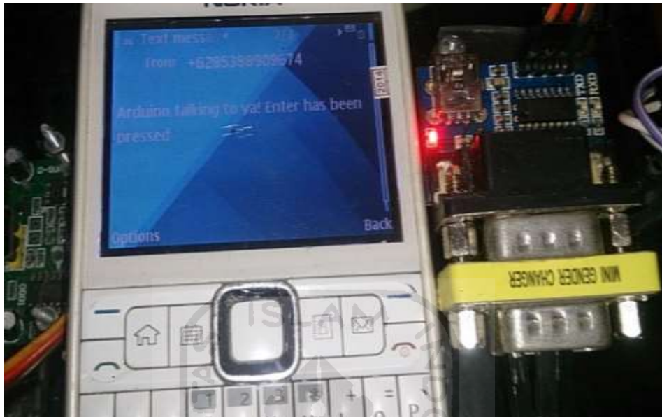
Gambar 4.2. Pengujian Modul RS232.
