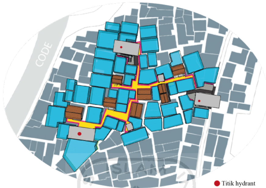
Gambar 3-14 Titik Penempatan Hydrant
