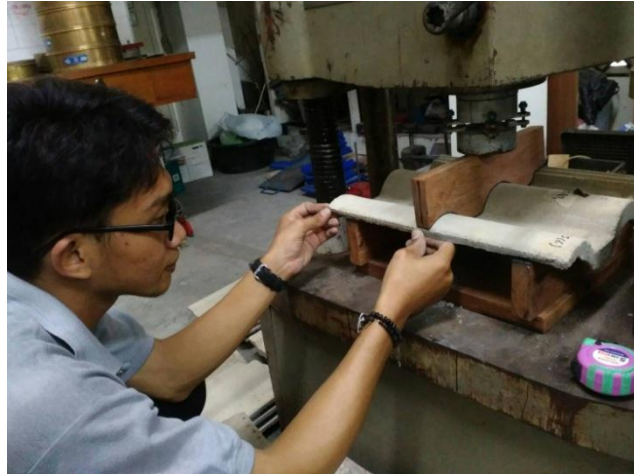
Gambar 5.43 Meletakkan penumpu bagian atas pada sumbu as
