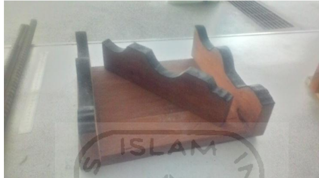
Gambar 5.41 Penunpu benda uji (genteng beton)
