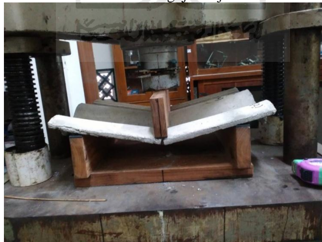
Gambar 5.45 Benda uji berada pada titik maksimal beban lentur
