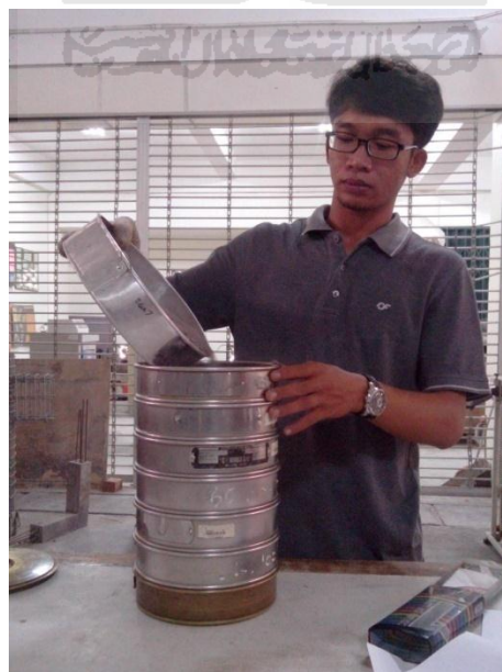
Gambar 5.20 Satu Set Saringan 4,80 mm; 2,40 mm; 1,20 mm; 0,60 mm; 0,30 mm; 0,15 mm
