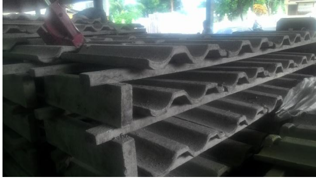
Tempat pengeringan genteng beton setelah selesai dicetak
