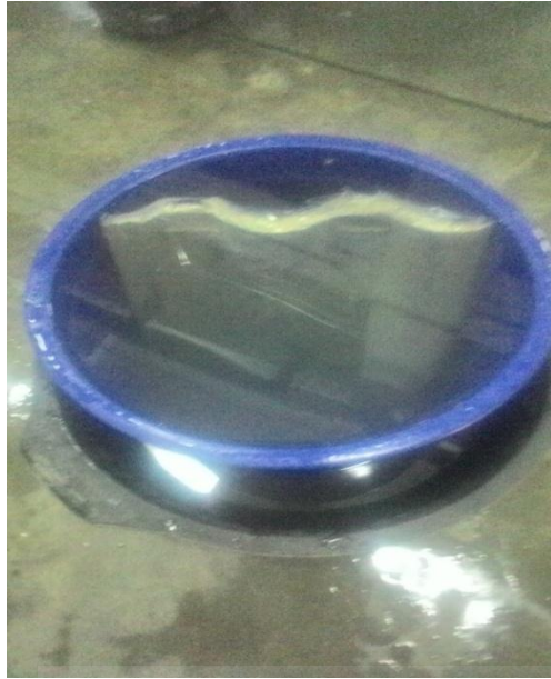
Gambar 5.58 Benda uji terendam kedalam media yang berisi air
