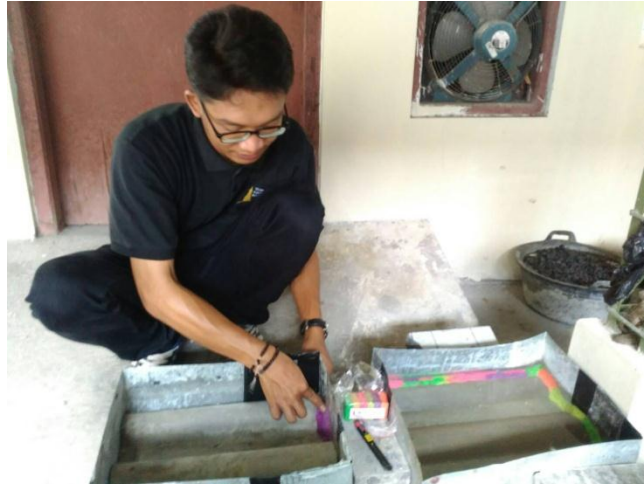
Gambar 5.51 Memasang lilin plastisin untuk uji rembesan
