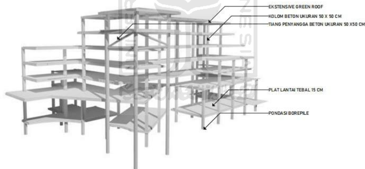
Gambar 3.16 Konsep struktur bangunan Sumber : Penulis 2021
