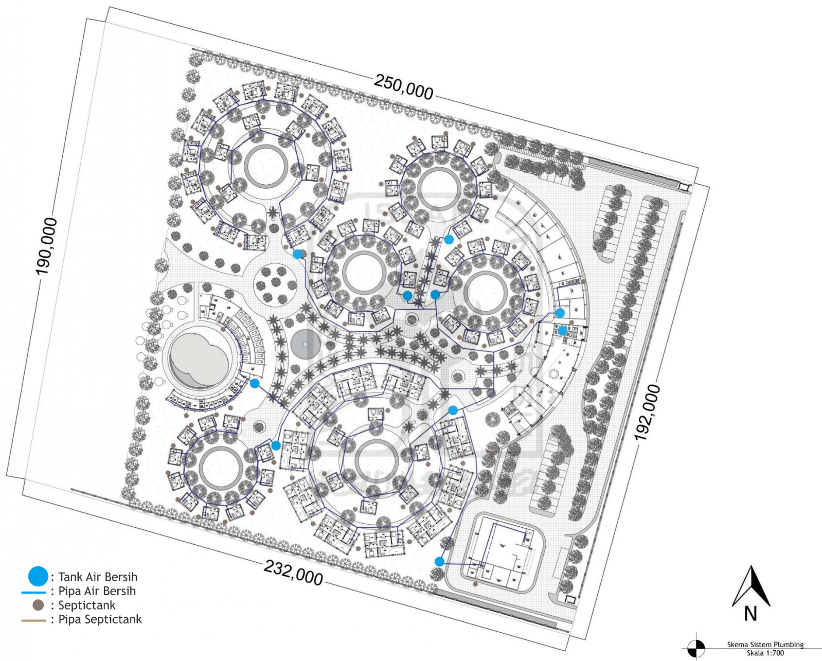
Gambar 7. 39 Skema Sistem Plumbing Sumber : Penulis, 2021
