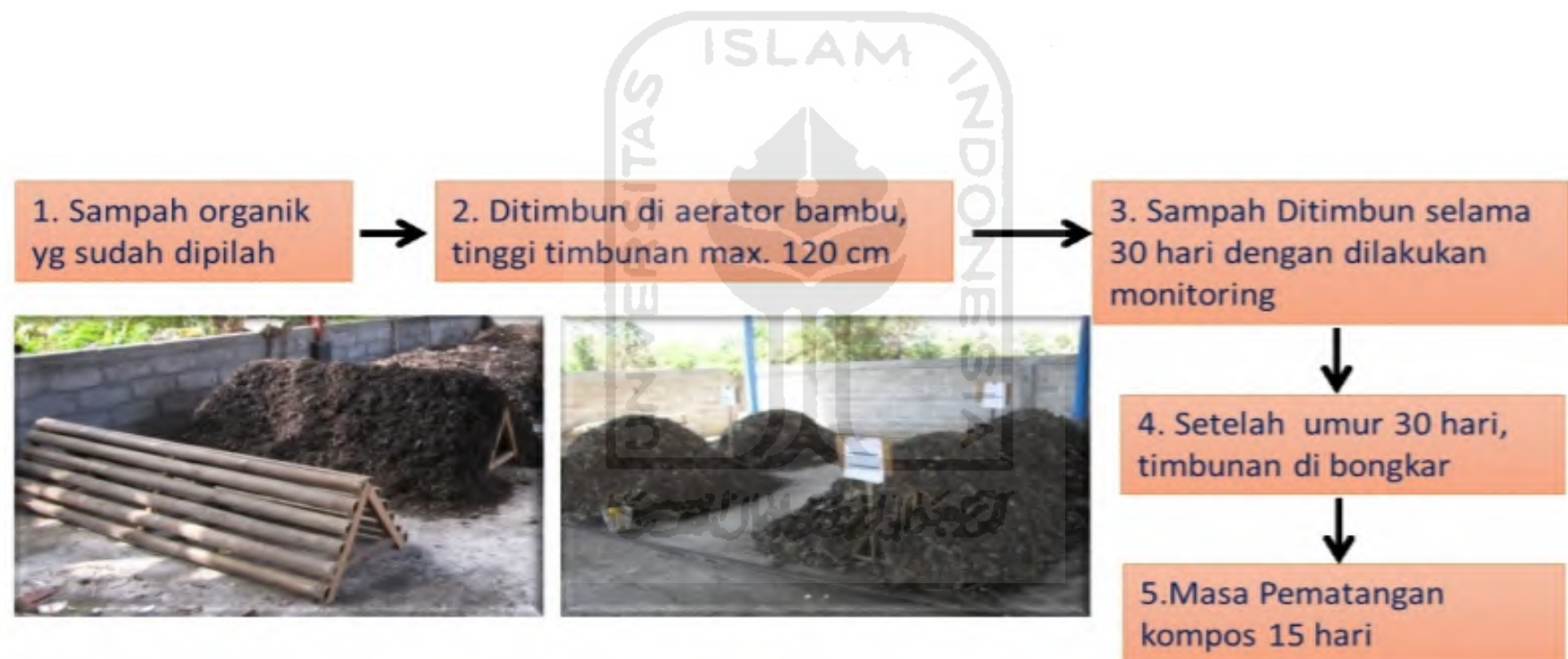
Gambar 2.36 Alur kerja aerator bambu
