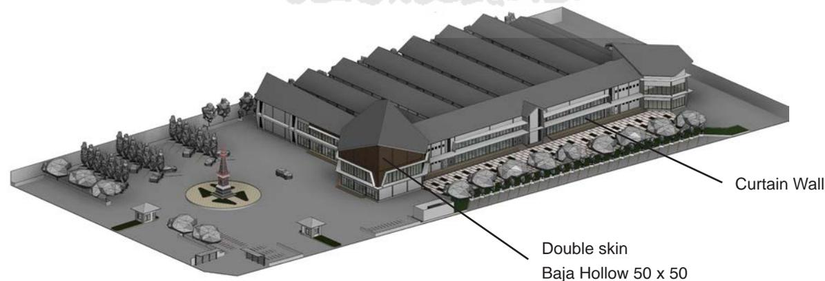
Selubung pembentuk bangunan menggunakan curtain wall sebagai salah satu cara untuk mengoptimalkan cahaya masuk kedalam ruangan. Dan dengan menggunakan baja hollow 50 x 50 sebagai aksesoris untuk memperkuat estetika dan bentuk bangunan.
