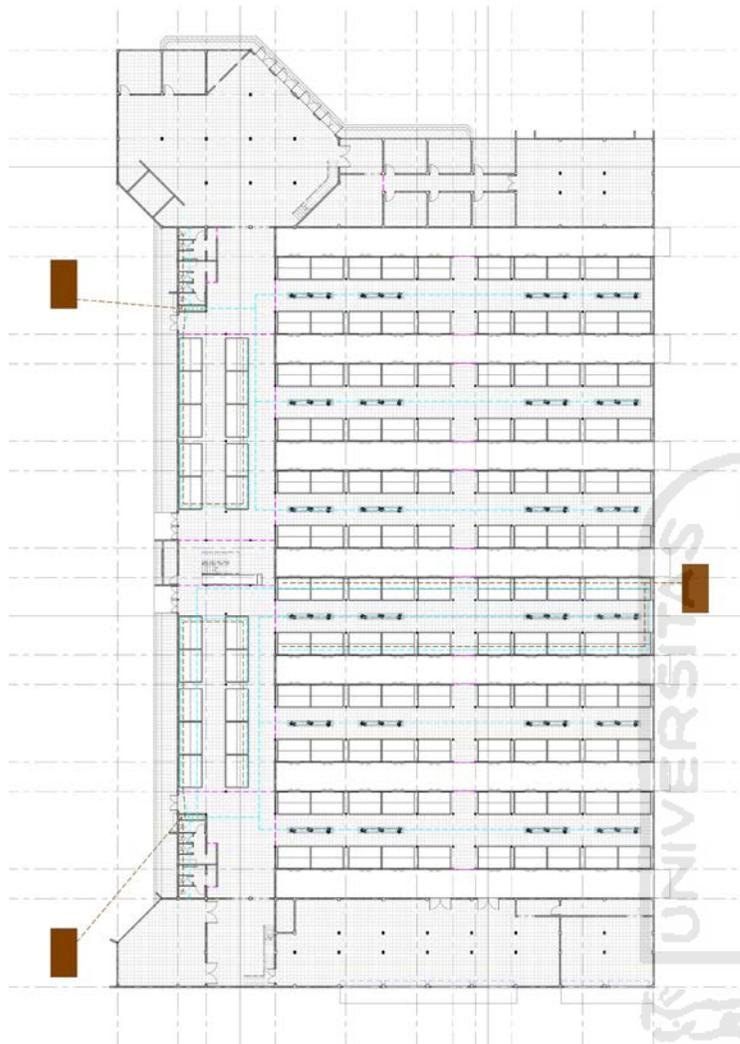
sistem plumbing terkonsentrasi di 2 titik yakni pada Utara dan Selatan. untuk kemudahan distribusi pipa. Dengan menjadikan satu sirkulasi maka sangat jelas sirkulasi maintenance tidak akan mengganggu performa kerja dari pengguna Pasar.
