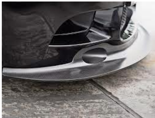
Gambar 2.11 Front Spoiler Yang Dipasang Dibawah Bemper.
