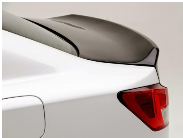
Gambar 2.10 Rear Spoiler (Ductile) Pada Mobil Lexus
