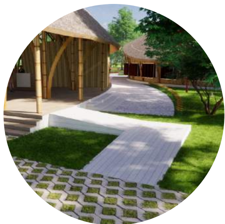
Ramp Difabel kemiringan 10%
