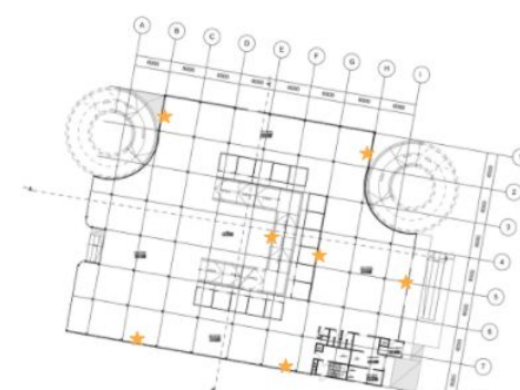
Gambar 5.41 Peletakan Tanda Dilarang Merokok Lantai Ground Floor
