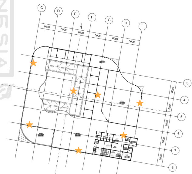
Gambar 5.43 Peletakan Tanda Dilarang Merokok Lantai Lantai 3
