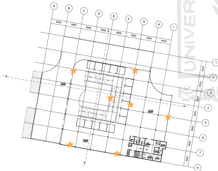
Gambar 5.42 Peletakan Tanda Dilarang Merokok Lantai Lantai 2
