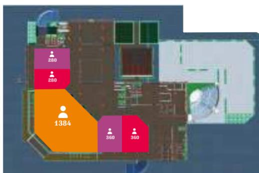
Gambar di samping menunjukkan kapasitas ruang jika auditorium, galeri dan ruang workshop pada lantai dasar dengan layout datar digabungkan untuk seminar atau pameran besar dapat memuat hingga sekitar 2664 orang. Penggabungan ruang menggunakan dinding temporer yang dapat terlipat keatas (skyfold wall).
