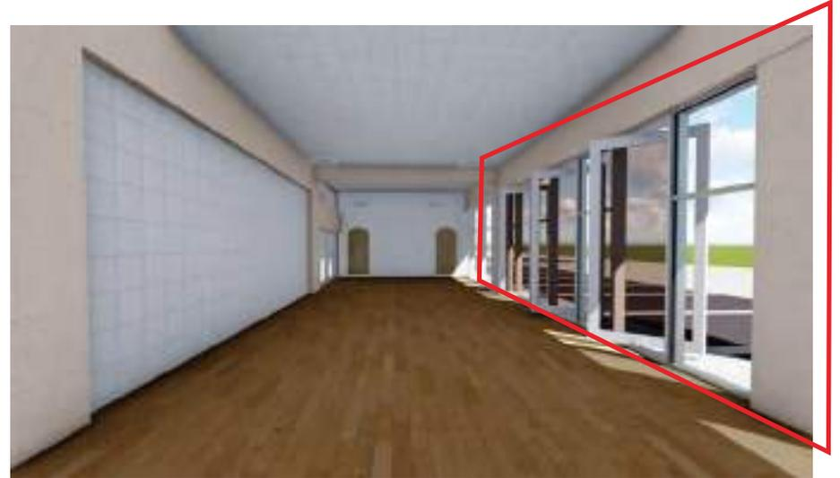
**Gambar 158. Perspektif Curtain Wall Kombinasi Jendela Pivot pada Bangunan**
