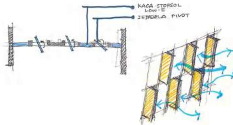
Gambar 106. Sketsa Konsep Potongan Curtain Wall
