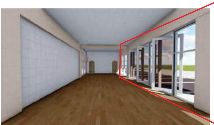
Gambar 142. Curtain Wall Kombinasi Jendela Pivot pada Koridor Pembatas
