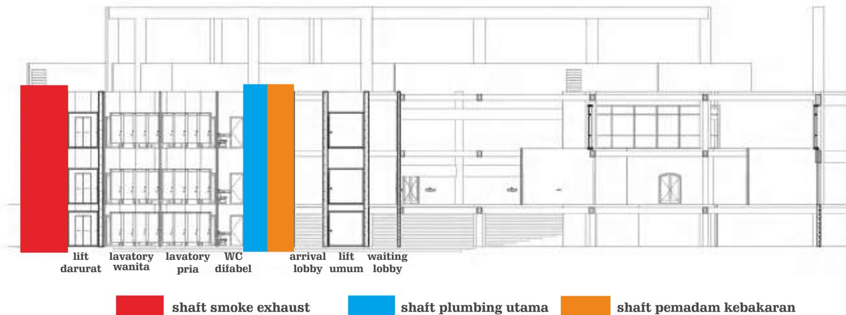
Gambar 114. Skema Potongan Sistem Infrastruktur Bangunan
