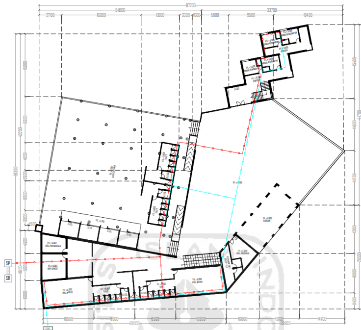
Gambar 6.5 Skema drainase sebelum perbaikan
