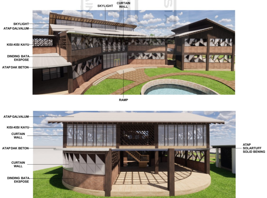
(Gambar 5.8 Skema Selubung Bangunan)
