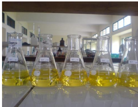
Gambar 35 Hasil metil ester ( biodiesel ) dengan 5 variasi volume katalis NaOH 1 M proses II
