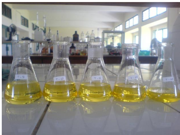
Gambar 25. Metil Ester (biodiesel) dengan 5 variasi volume katalis NaOH 1 M proses I
