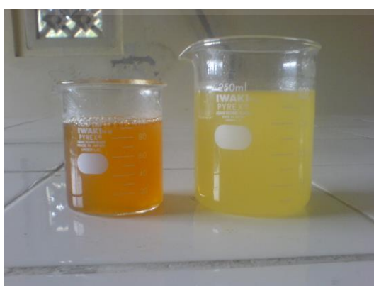
Gambar 19. Hasil transesterifikasi yang telah dipisahkan
