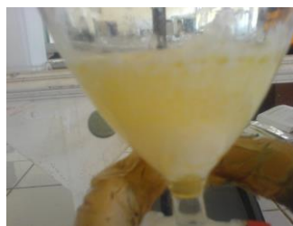
Gambar 22. Pencucian metil ester dengan aquades terjadi emulsi
