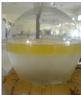
Gambar 23. Pencucian aquades sampai lapisan bawah bening
