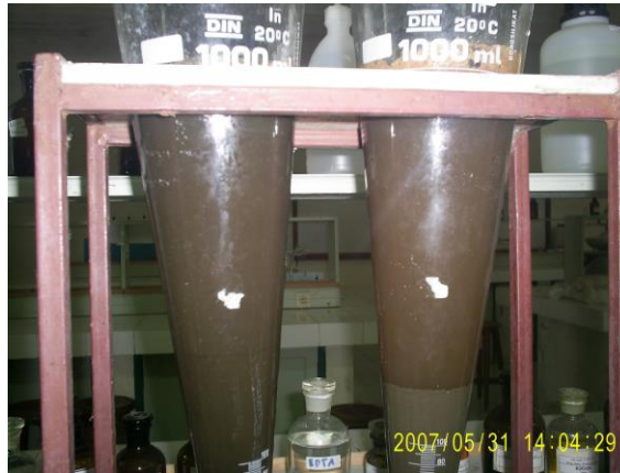
Gambar 4.11 Percobaan jar test dengan menggunakan variasi ferro sulfat dan kapur tohor
