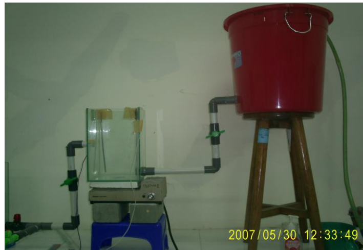
Gambar 4.1 Bak Elektrokoagulasi dan magnetic steer barr
