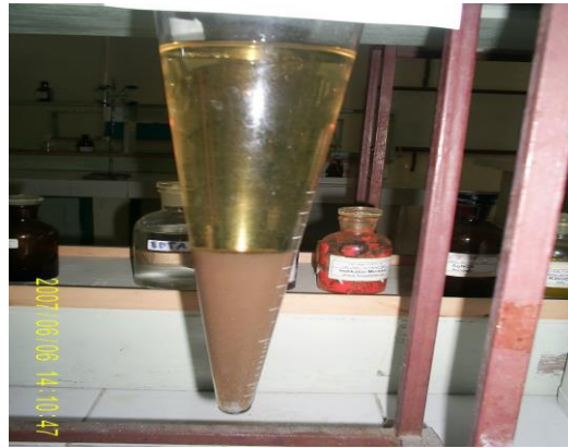
Gambar 4.13 Percobaan elektrokoagulasi menggunakan tawas 8 gr/500ml
