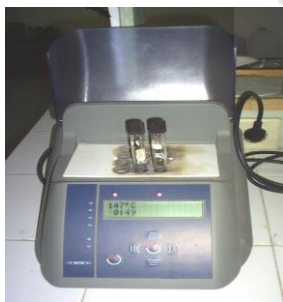
Gambar 3.4 Pemanasan Tabung Refluks Tertutup
