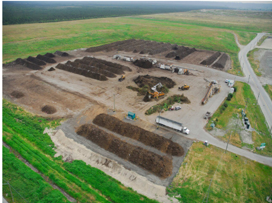
Gambar 3.25 Pengolahan Kompos dengan Metode Wind Row System Sumber technoparksurakarta.go.id
