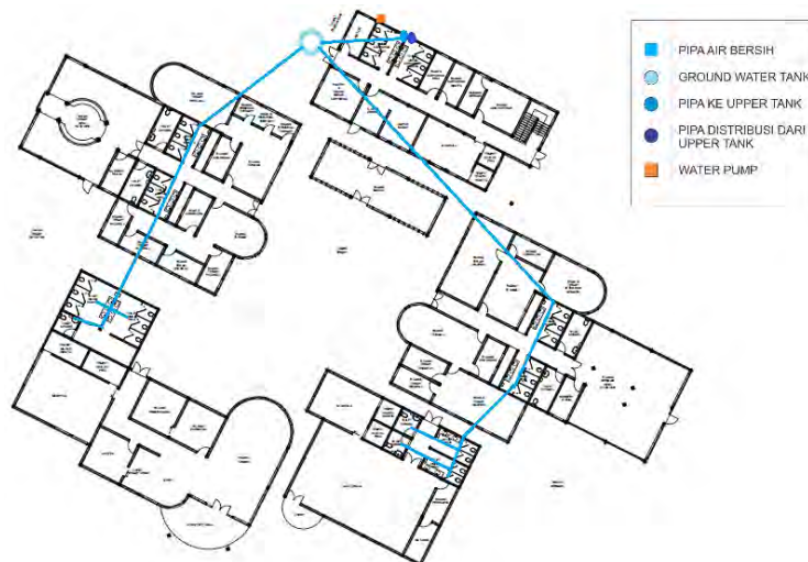
Gambar 4.13 Rancangan Sistem Air Bersih
