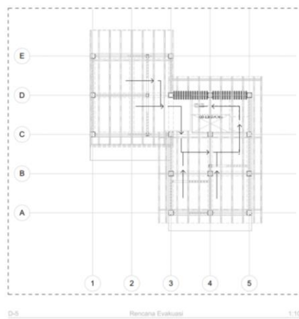
Gambar 5. 27 Jalur Evakuasi Rumah Tipe 3 Lantai 2 (Penulis, 2020)
