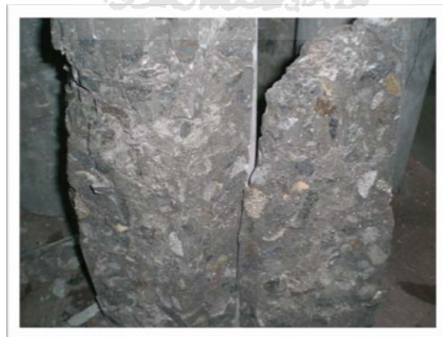
Gambar 5.6 Pecahan Beton Setelah Diuji Desak
