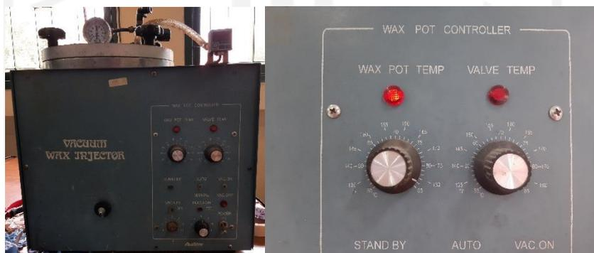
Gambar 3-15 Pengaturan *Wax Pot Temp* dan *Valve Temp*
