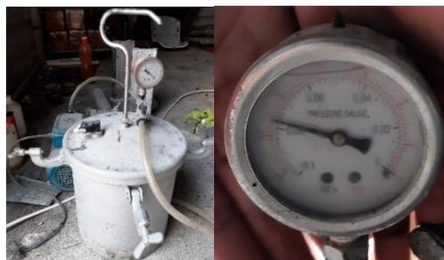
Gambar 3-14 Proses vakum cetakan silikon
