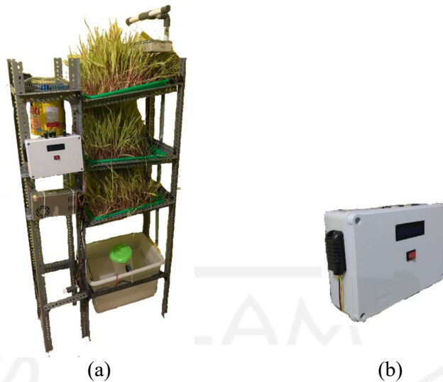
Gambar 4.2 Hasil realisasikan desain mekanik; (a) Kerangka sistem akuaponik, (b) box elektronik
