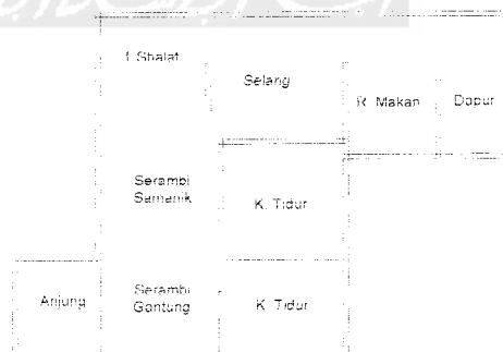
Gambar 2.33 Denah rumah Melayu Sumber : Lim Lee Yuan, The Malay House
