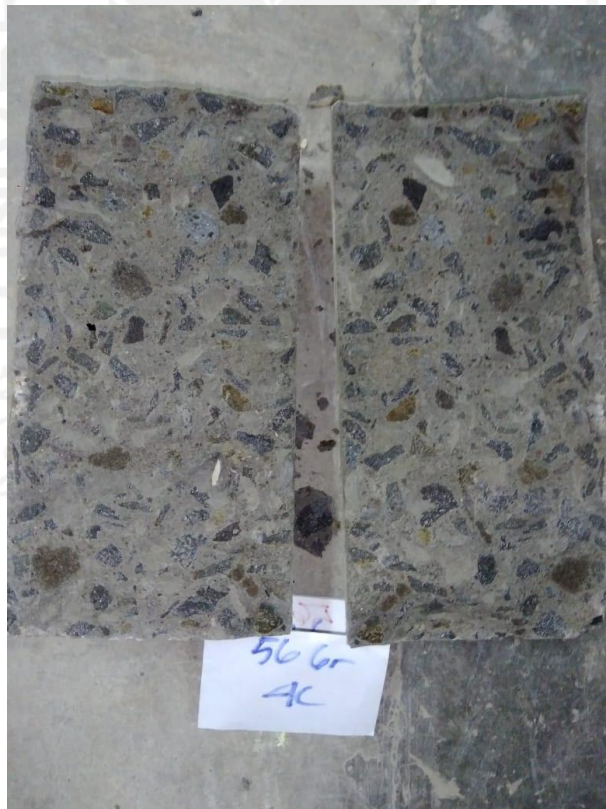
Gambar L-3. 32 Hasil Pengujian Kuat Tarik Belah
