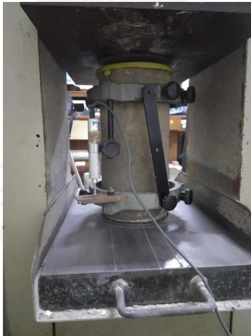
Gambar L-3. 30 Pengujian Kuat Tekan
