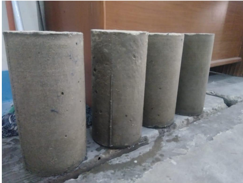
Gambar L-3. 27 Benda Uji Setelah Direndam
