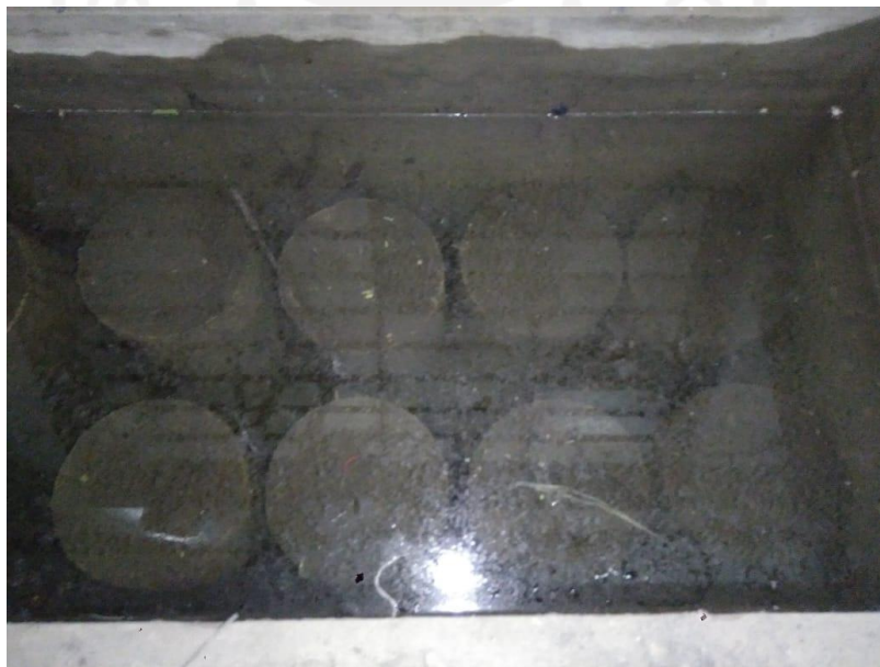
Gambar L-3. 26 Perendaman Benda Uji
