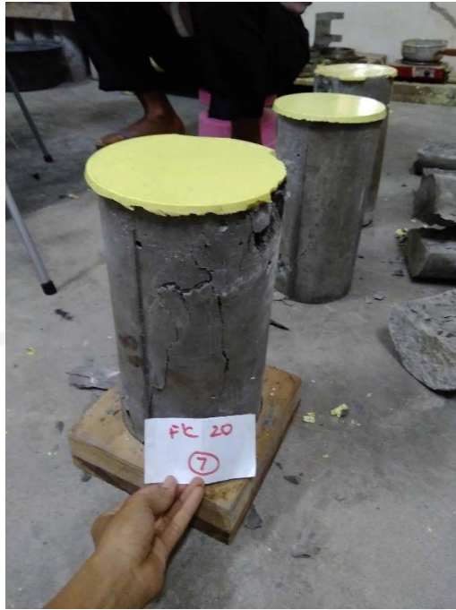
Gambar L-3. 31 Hasil Pengujian Kuat Tekan
