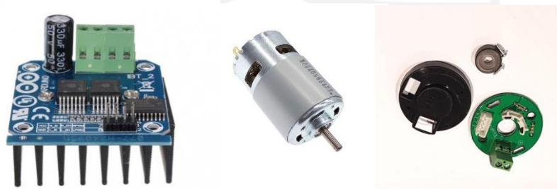
Gambar 2. 4 BTS 7960 dan Motor DC RS775 dengan Encoder
