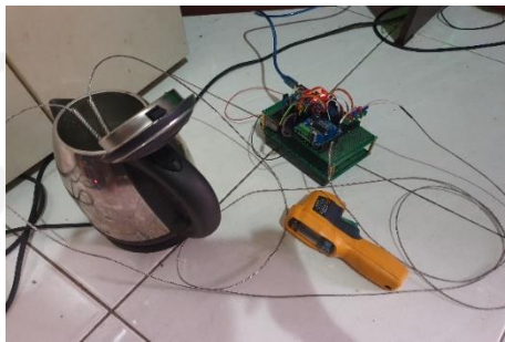
Gambar 4. 1 Kegiatan Pengujian Proses Kalibrasi Sensor Temperatur
