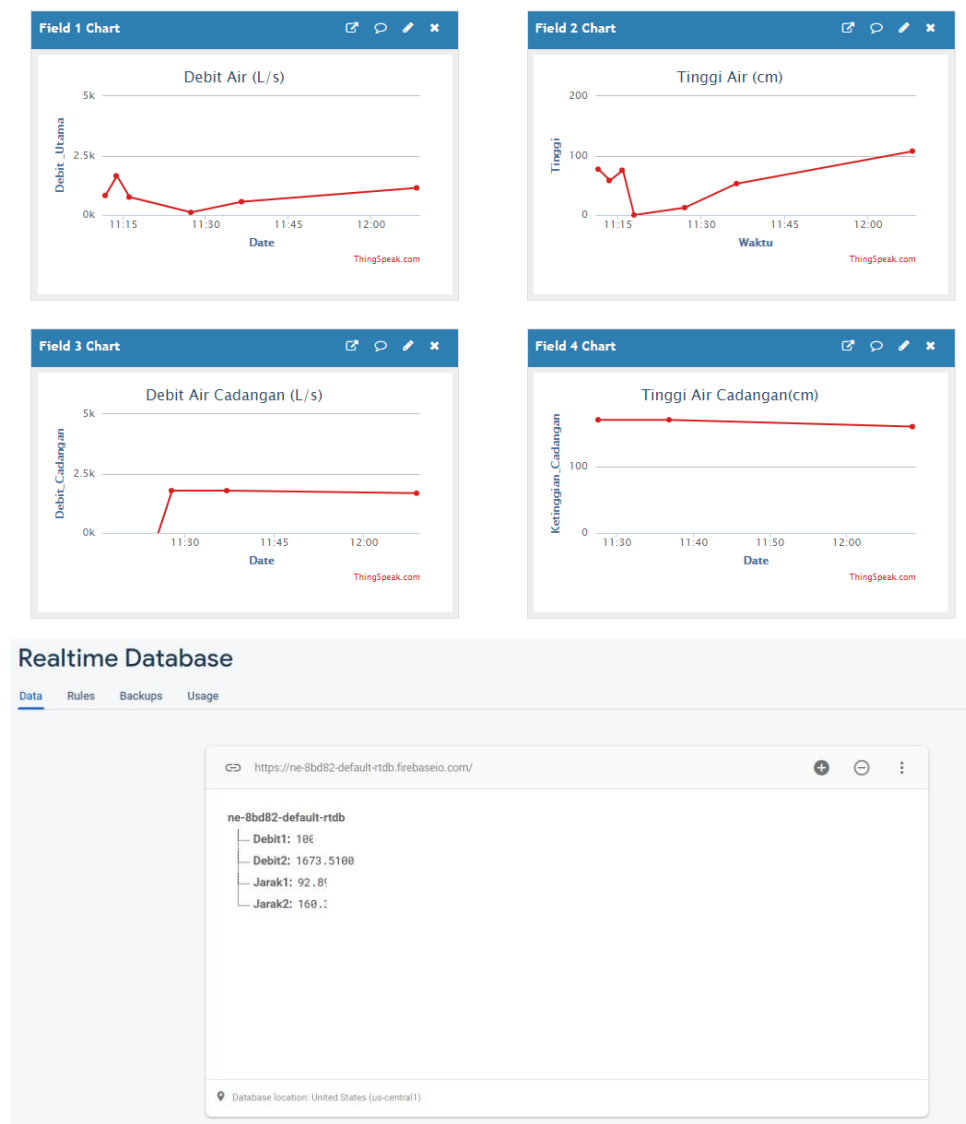
Gambar 3.17 Desain Antarmuka User Thingspeak.com dan Firebase
