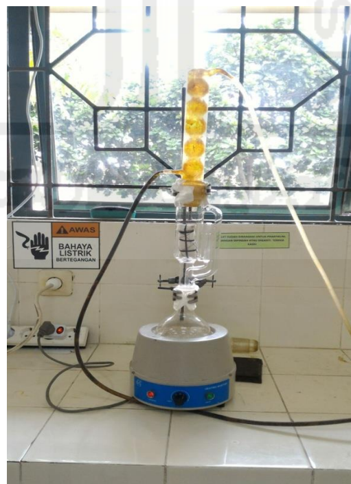
Lampiran 19. Gambar Proses Sokletasi Pada Uji Lemak
