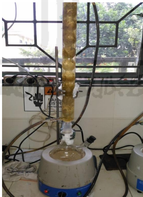
Lampiran 9. Gambar Proses Hidrolisis Menggunakan Refluks Pada Uji Serat Kasar
