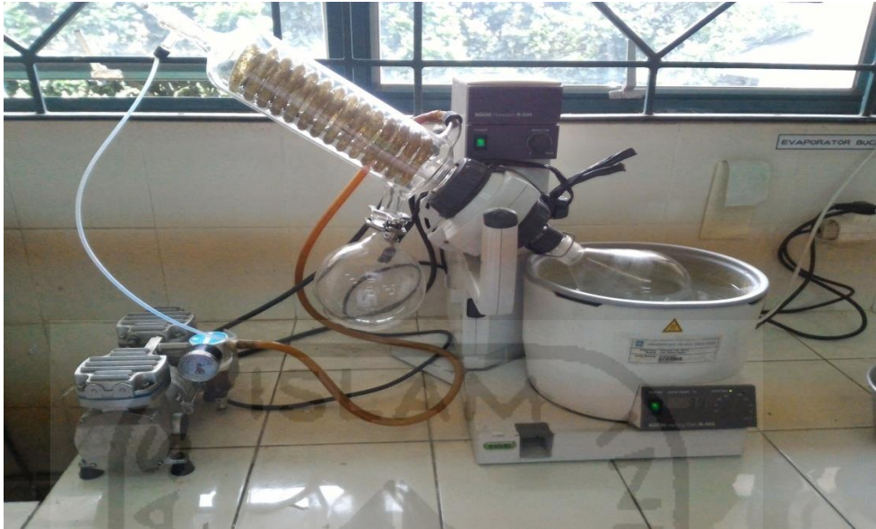
Lampiran 20. Gambar Proses Evaporasi Pada Uji Lemak
