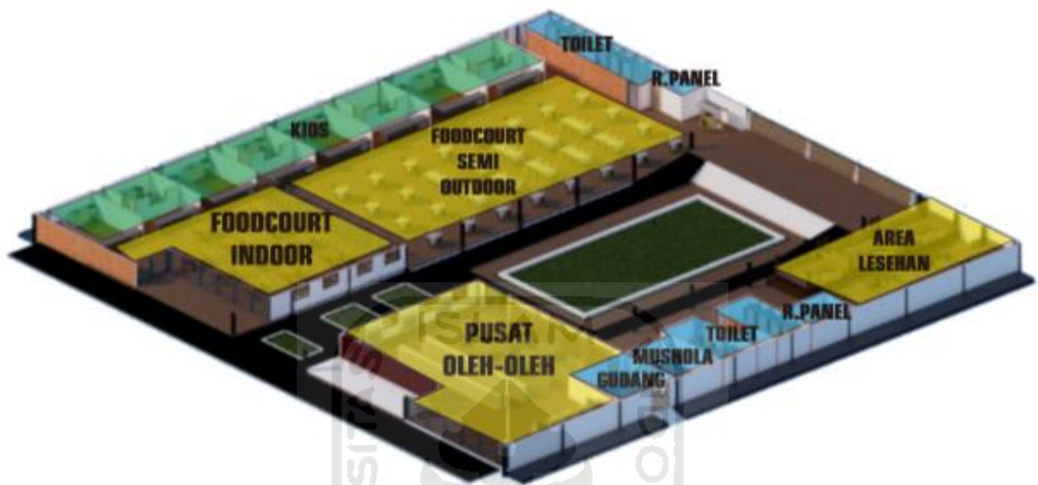
Gambar 5.2 Denah Bangunan Sumber: Analisa Penulis
