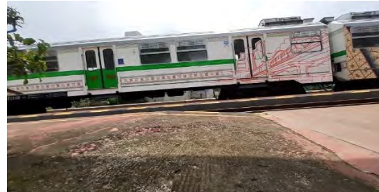
Gambar 1.5 Perbedaan Ketinggian Peron Stasiun Sentolo dengan Kereta Api
