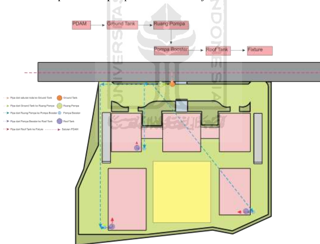
Gambar 4.1.8 a Saluran Air Bersih
