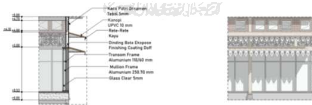
Gambar 5.17.2 Detail Selubung Bangunan Showroom
