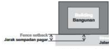
Gambar 4.2.1.1 b Jarak Sempadan Bangunan
