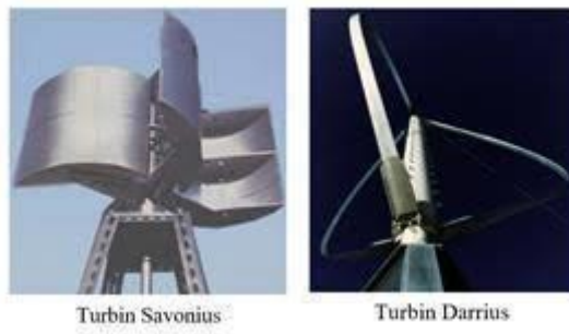
Gambar 2-3 Turbin sumbu Angin Sumbu Vertikal [11]
