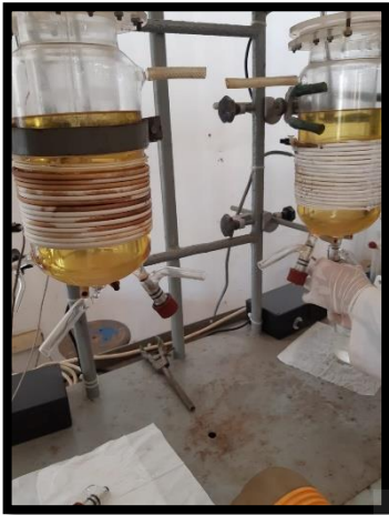
Reaktor gelas berpengaduk bench scale untuk sintesis zirkonil nitrat
