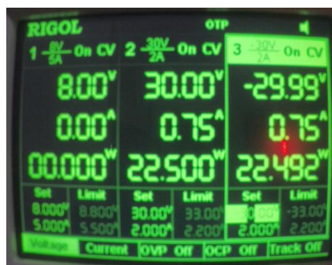
Gambar 4.16 Data Tegangan, Arus dan Daya Masukan
