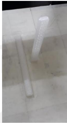
Gambar 4-2 Gambar pencetakan specimen secara vertikal dan horizontal
