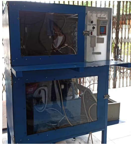
Gambar 4- 32 Hasil akhir mesin vulkanisasi karet.
