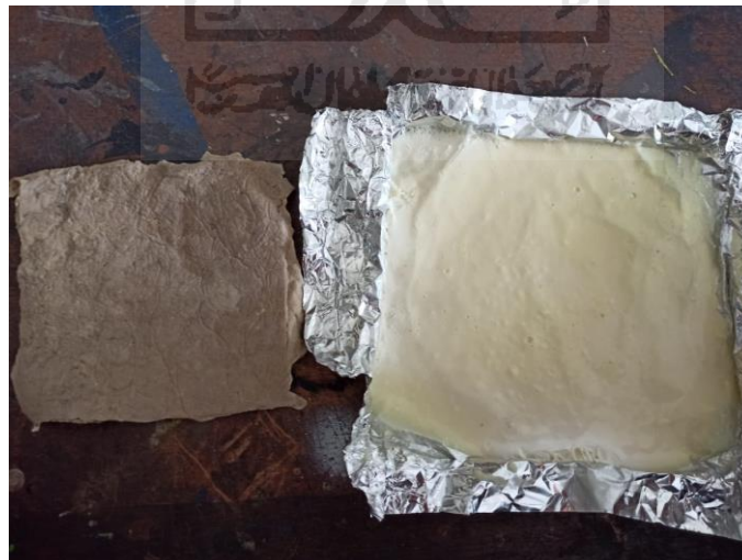
Gambar 4- 34 (Kiri) material yang telah divulkanisasi dan (kanan) material yang belum divulkanisasi.
