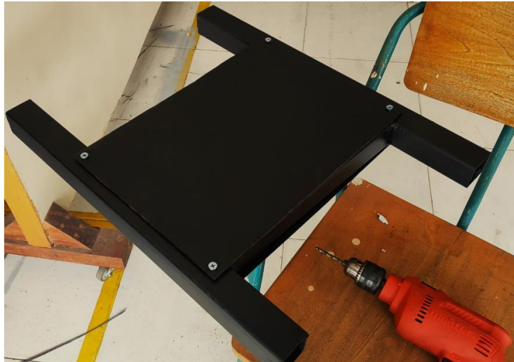
Gambar 4- 25 Hasil pengecatan cat tahan panas pada pemanas mesin vulkanisasi.
