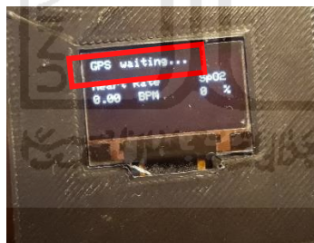
Gambar 4.7 Status GPS saat mendapatkan sinyal pada prototipe
