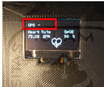
Gambar 4.6 Status GPS sebelum mendapatkan sinyal pada prototipe
