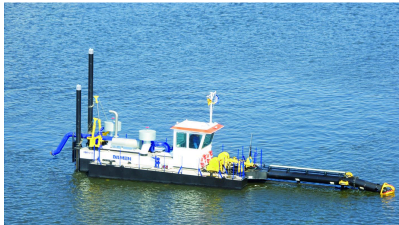
Gambar 5. 18 Kapal keruk tipe CSD 250
