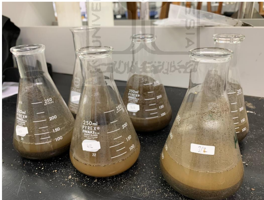
Gambar 3.6 Tahap memisahkan Residu dengan menambah NaCl jenuh
