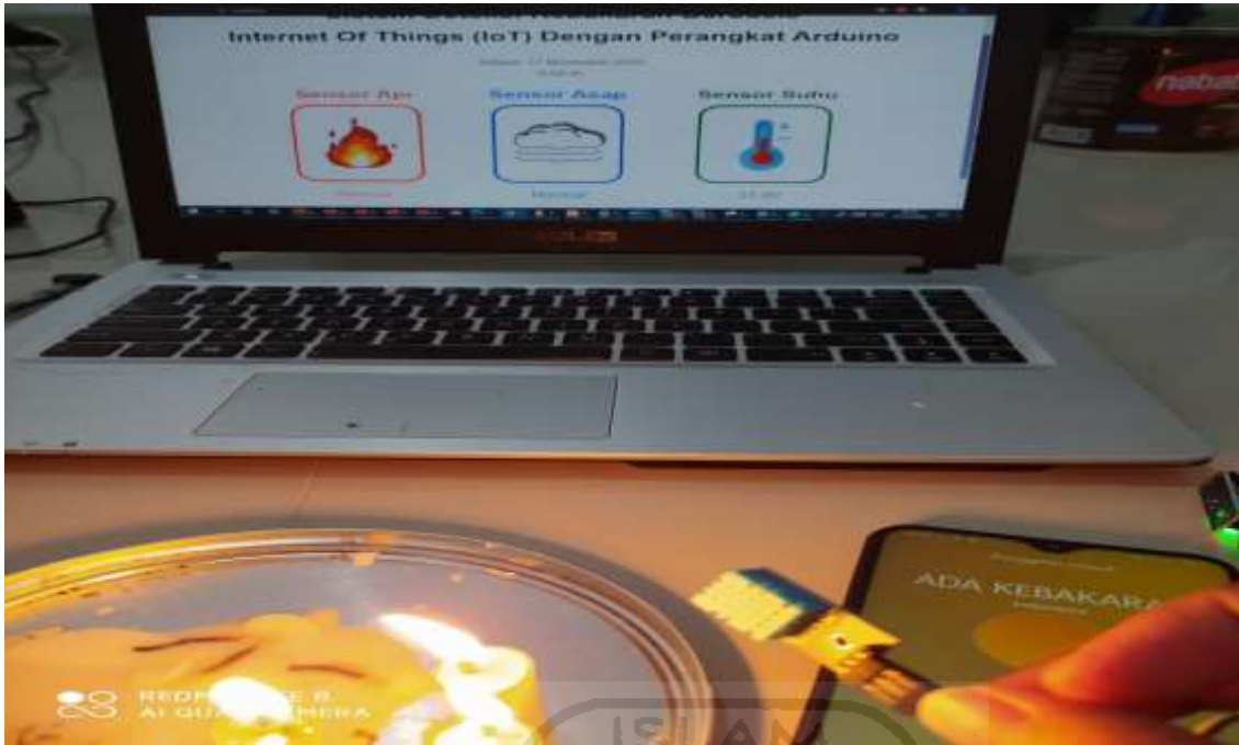
Gambar 4.15 pengujian sensor suhu
