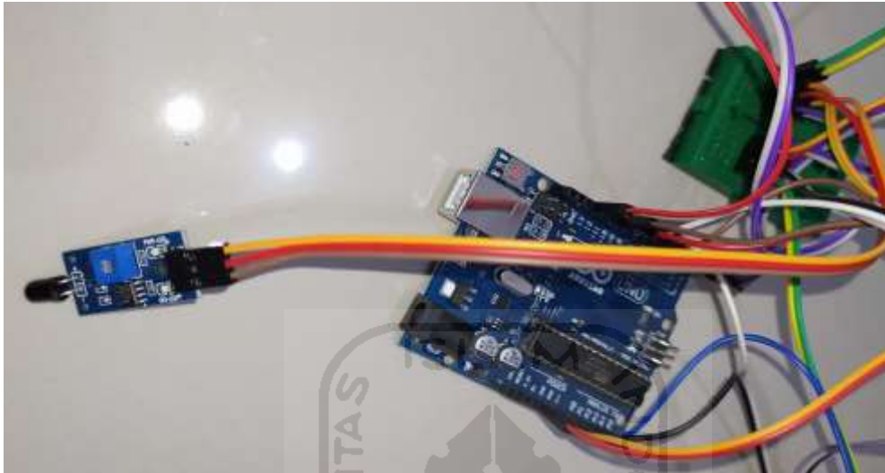
Gambar 3.5 Perancangan sensor api
