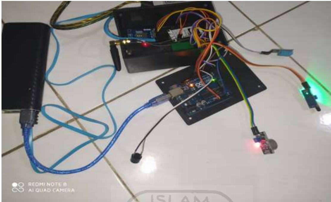
Gambar 4.1 Hardware sistem deteksi kebakaran
