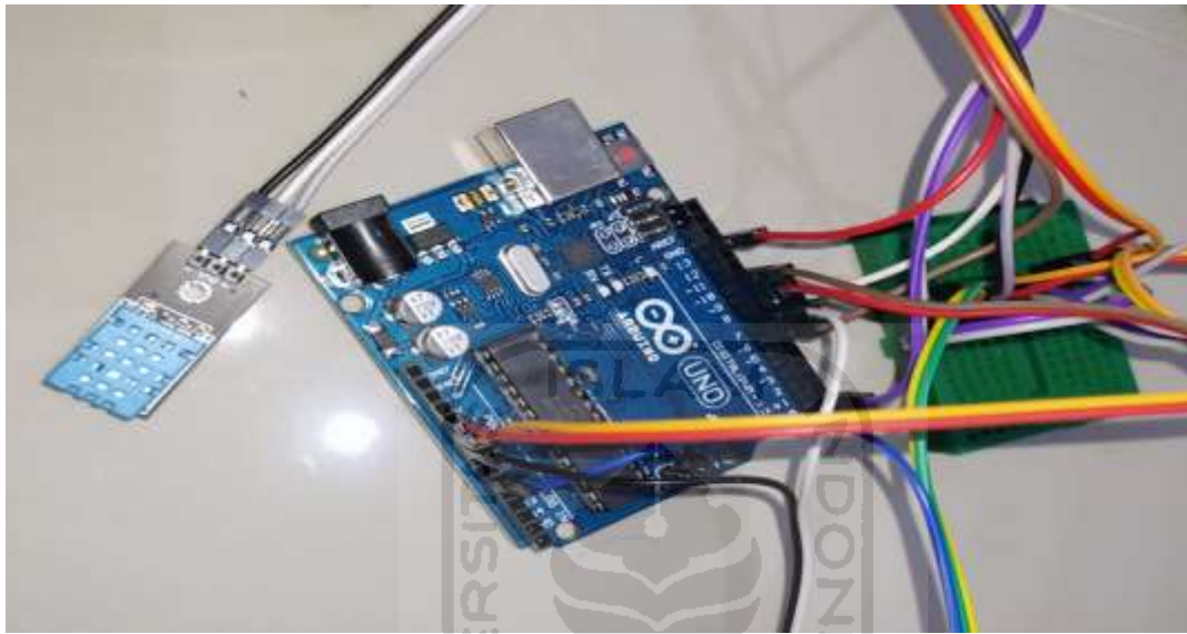
Gambar 3.6 Perancangan sensor suhu
