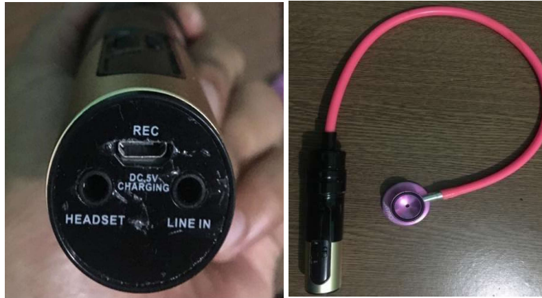
Gambar 3.2 Stetoskop elektronik modifikasi
