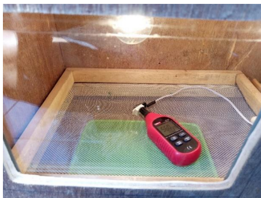
Gambar 4.2 Uji Coba Pengujian Akurasi Sensor DHT 22 dan UNI-T
