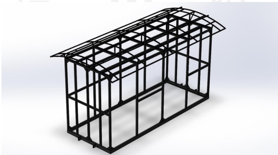
Gambar 4-24 Kerangka Ekspansi Atas dan Atap Modifikasi Peti Kemas
