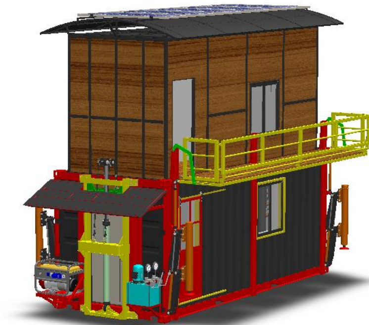
Gambar 4-38 Hasil Perancangan Rumah Peti Kemas Tampak Isometris
