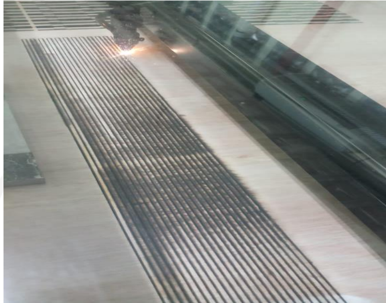
Gambar 4-41 Proses Eksekusi Laser cutting Menggunakan Tipe File DXF
