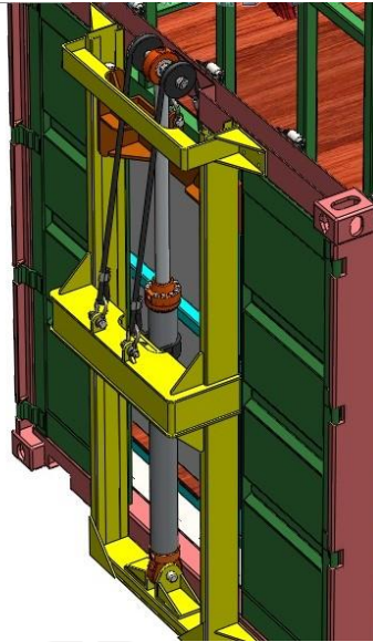
Gambar 4-23 Posisi Kerangka Hidrolik dan Braket Hidrolik
