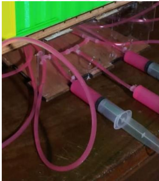
Gambar 4-49 Media Penggerak Mekanisme Vertikal Dan Kaki Semu Rumah Peti Kemas
