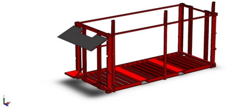
Gambar 4-14 Modifikasi Kerangka Utama Peti Kemas
