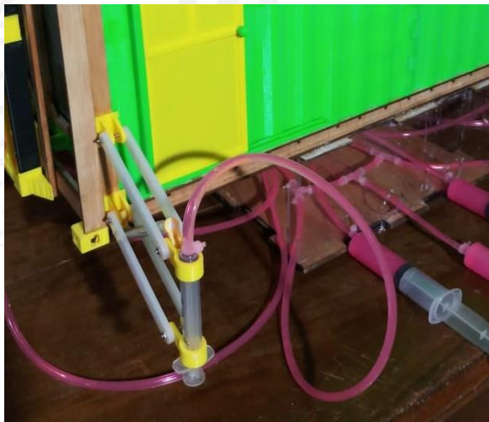
Gambar 4-48 Pemodelan Mekanisme Kaki Semu Pada Rumah Peti Kemas
