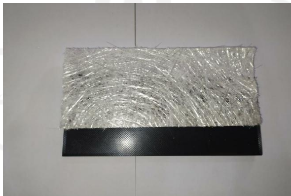
Gambar 3.10 Susunan 3DP + Fiberglass Siap Dilaminasi
