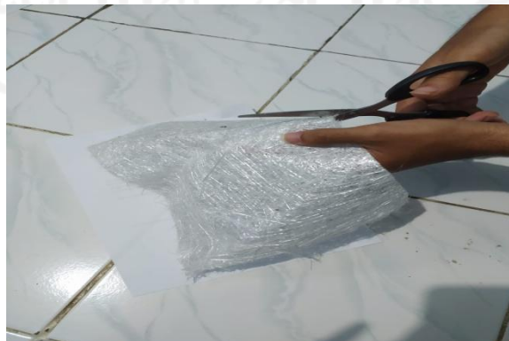
Gambar 3.7 Proses Pemotongan Fiberglass
