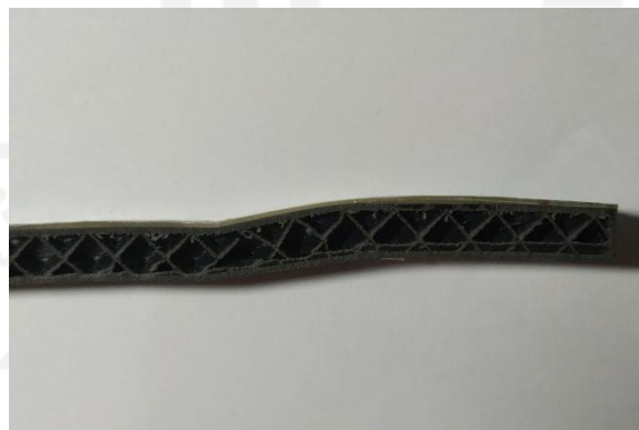
Gambar 4.5 Spesimen 1 Mengalami Gagal Face Wrinkle
