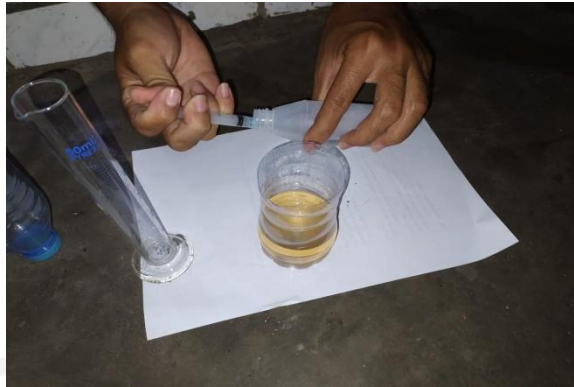
Gambar 3.11 Proses Pencampuran Resin dan Katalis
