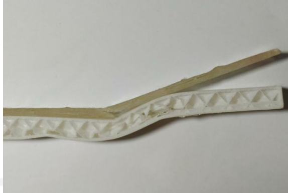
Gambar 4.6 Spesimen 11 Mengalami Gagal Delaminasi
